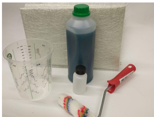
Rys. 2. Zestaw do zabezpieczenia rys – żywica i mata z włókna.
