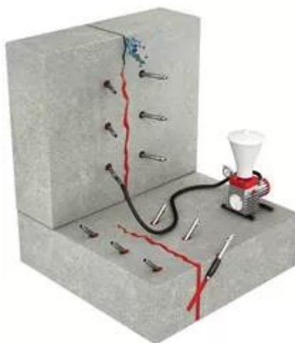
Rys. 1. Iniekcja ciśnieniowa rys.
