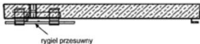
Rys. 7. Pokrywa z ryglem przesuwany
