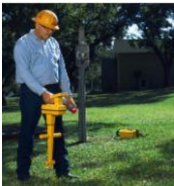
Rys. 40. Lokalizowanie i pomiar głębokości znaczników elektromagnetycznych
