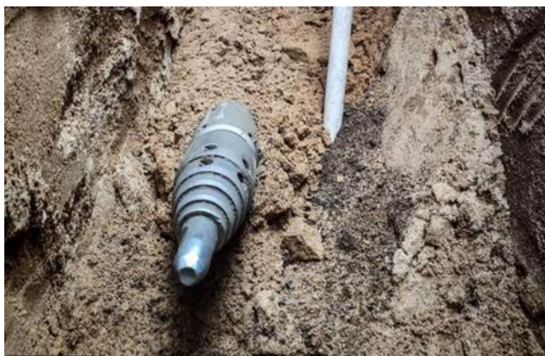
Rys. 27. Kret ciągnący rurę
