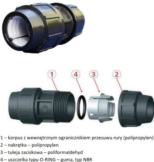
Rys. 23. Przykład złączki skręcanej do rury światłowodowej
