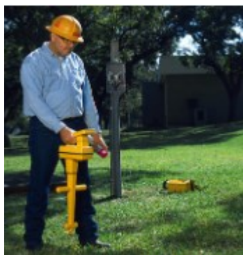
Rys. 40. Lokalizowanie i pomiar głębokości znaczników elektromagnetycznych
