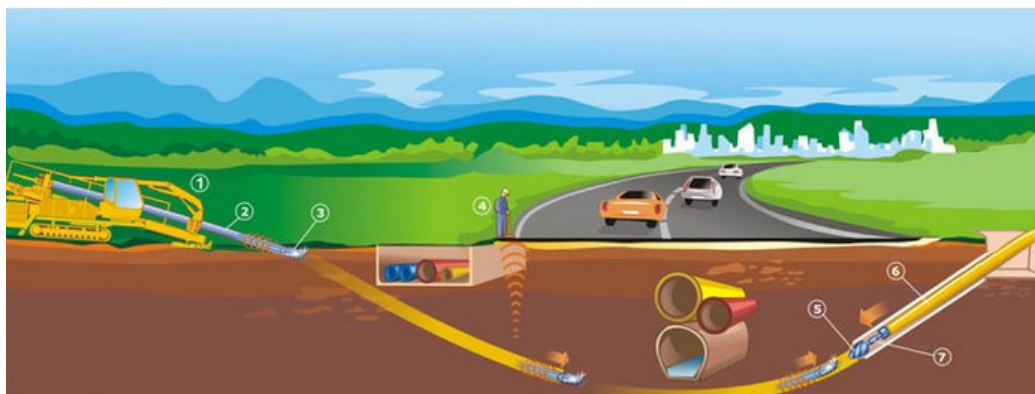
Rys. 29. Wykonywanie otworów pod kanalizację kablową metodą przewiertu
