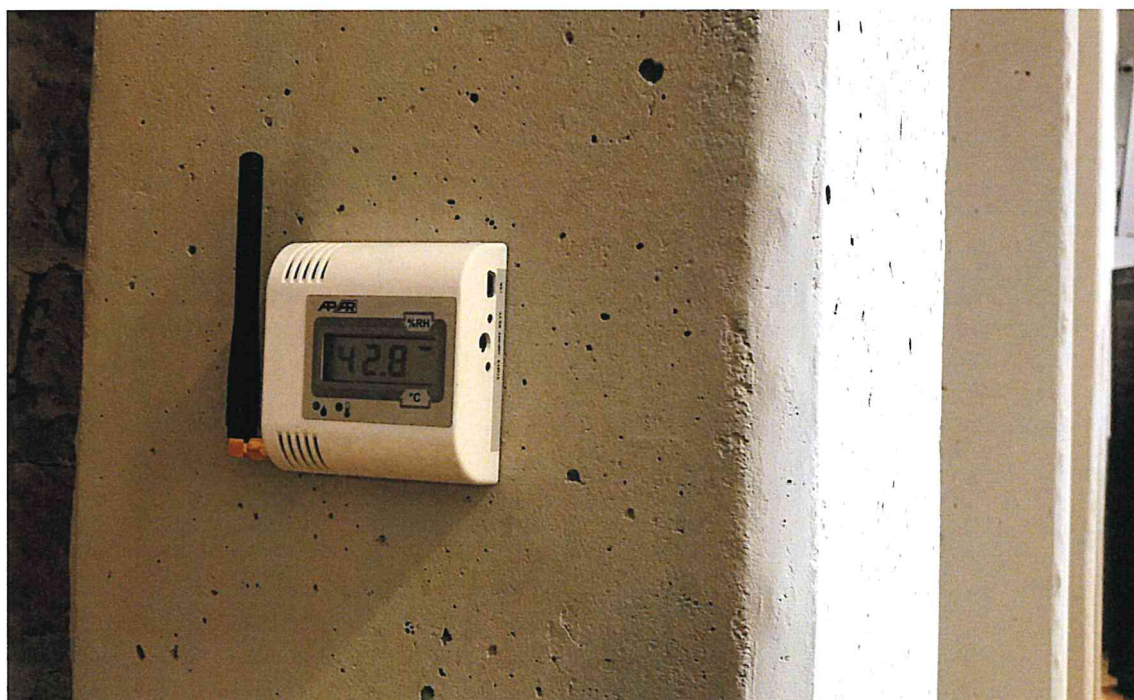
Fot. 88 Pomiary w pomieszczeniu reliktu na słupie betonowym, w niższej części pomieszczenia.
