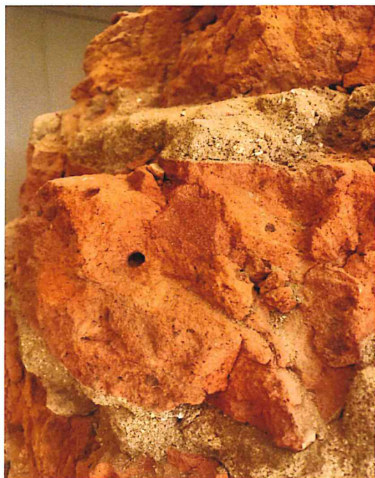
Fot. 73 Pomiar wilgotności i temperatury w części nasłonecznionej wewnątrz muru na ziemi.
