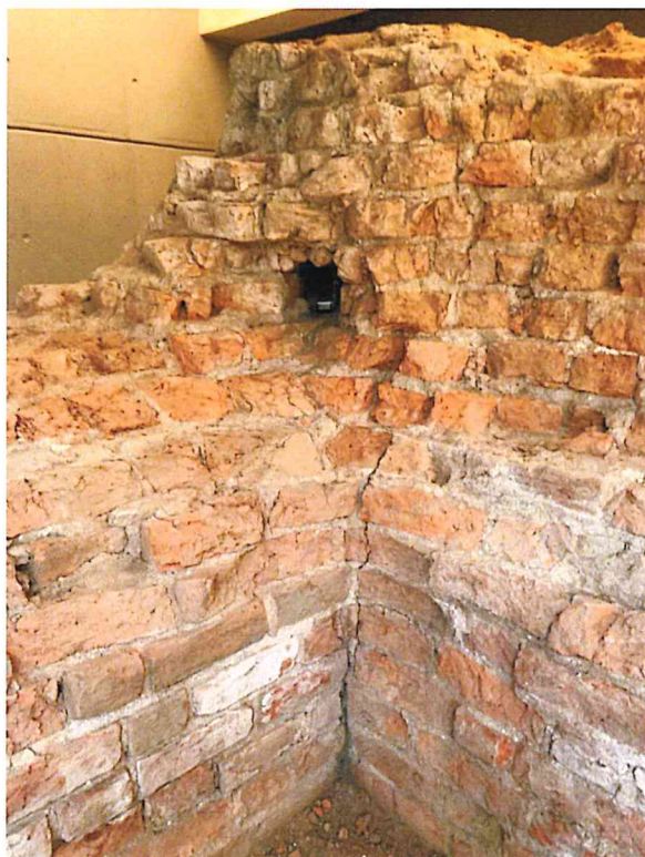
Fot. 76-79 (nr 1, 2,3,4), stanowiska pomiaru wilgotności i temperatury, na zewn. muru i wewnątrz ( w zagłębieniu otworów szachulcowych).
