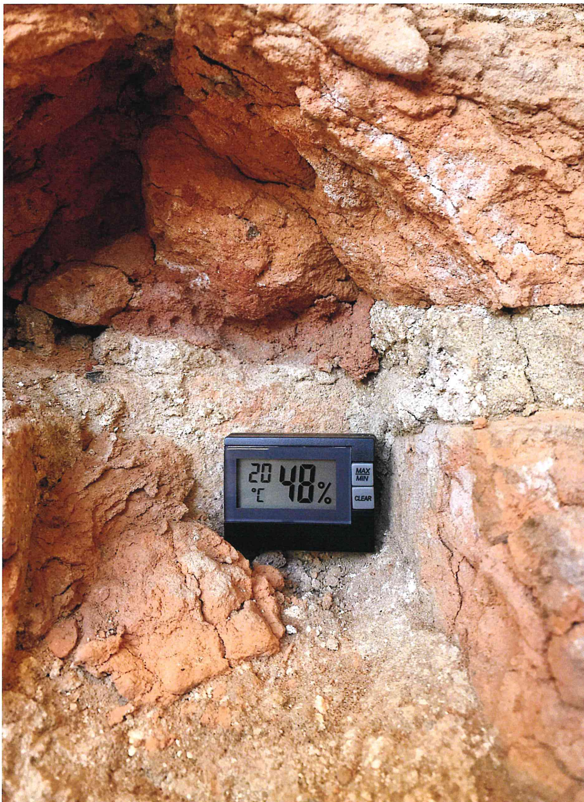
Fot. 80 Przykładowy pomiar wilgotności i temp.
