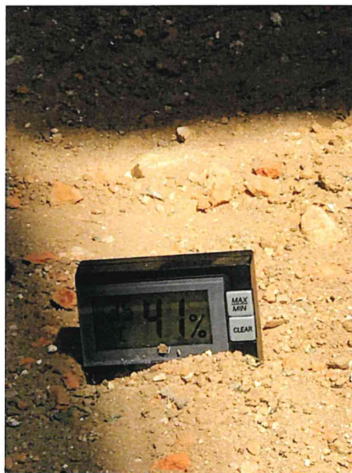
Fot. 73 Pomiar wilgotności i temperatury w części nasłonecznionej wewnątrz muru na ziemi.
