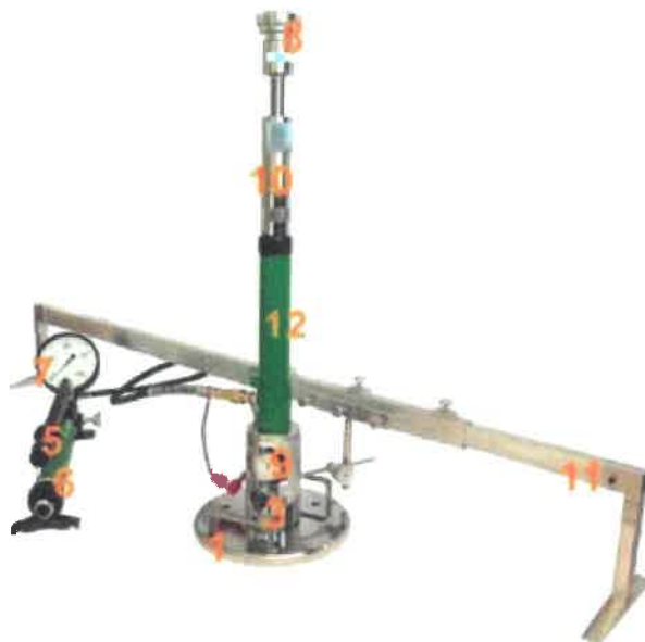
Rys. 1.2 Aparatura VSS z jednopunktowym pomiarem przemieszczenia płyty
