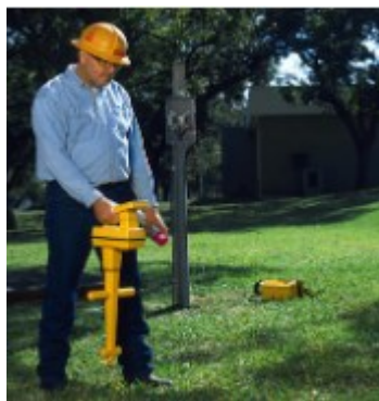
Rys. 40. Lokalizowanie i pomiar głębokości znaczników elektromagnetycznych
