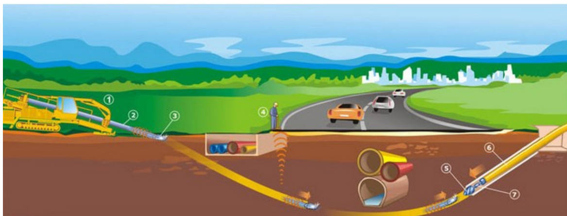
Rys. 29. Wykonywanie otworów pod kanalizację kablową metodą przewiertu
