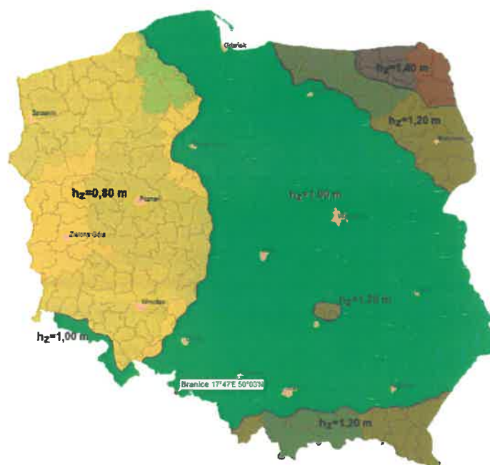
Rys.4 Orientacyjna mapa umownych stref przemarzania gruntu wg PN-81/B-03020
