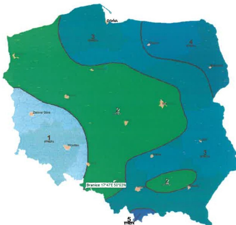
Rys.2 Orientacyjna mapa stref obciążenia śniegiem wg PN-EN 1991-1-3
