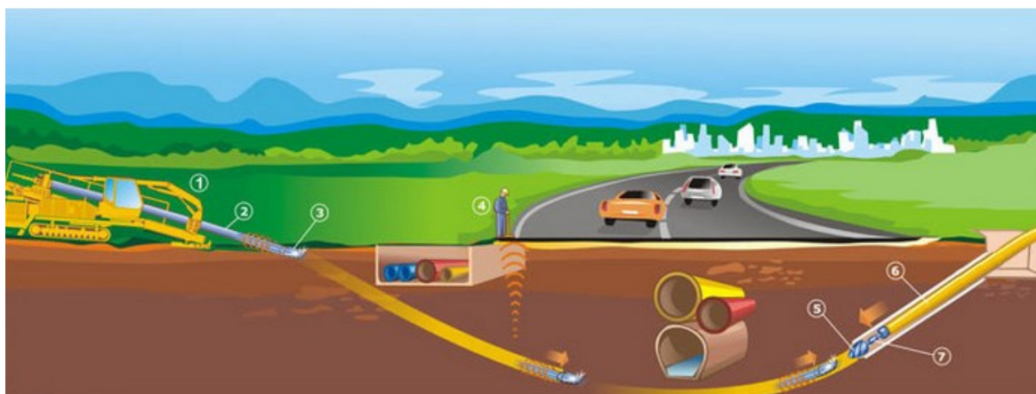
Rys. 29. Wykonywanie otworów pod kanalizację kablową metodą przewiertu
