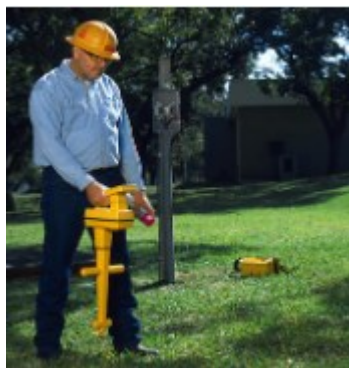
Rys. 40. Lokalizowanie i pomiar głębokości znaczników elektromagnetycznych
