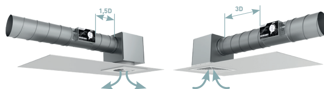
Rysunek 3. Wymagane odcinki proste przed i za regulatorem.
