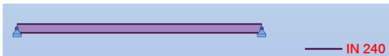
Rys.3. Model obliczeniowy belki stropowej w sali hybrydowej
