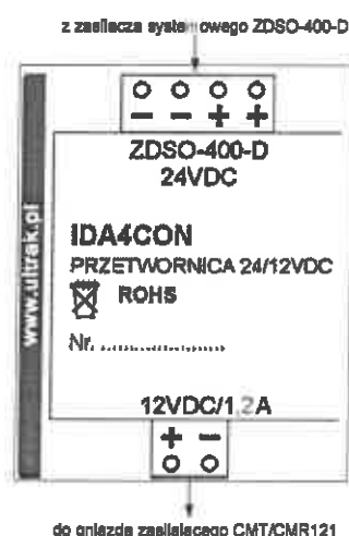
Rys8. Rozmieszczenie złącz zasilających konwertera IDA4CON
