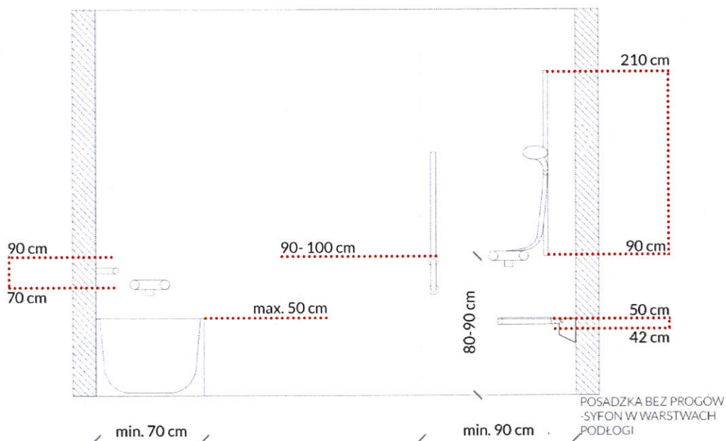
Wymiary prysznic, wanny oraz elementów towarzyszących dostępnych dla osób z niepełnosprawnościami
