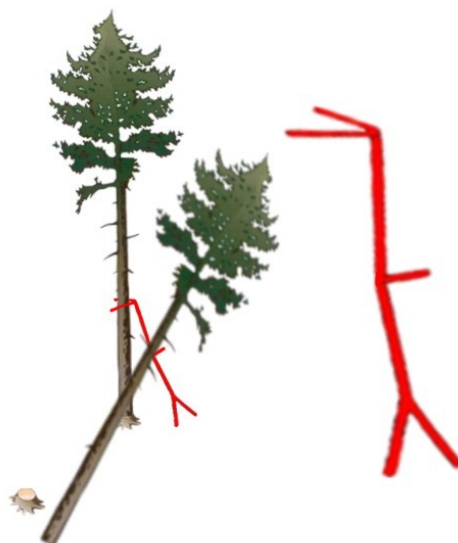
Rys.39 Drzewo podniesione do okrzysywania na widelkach.
