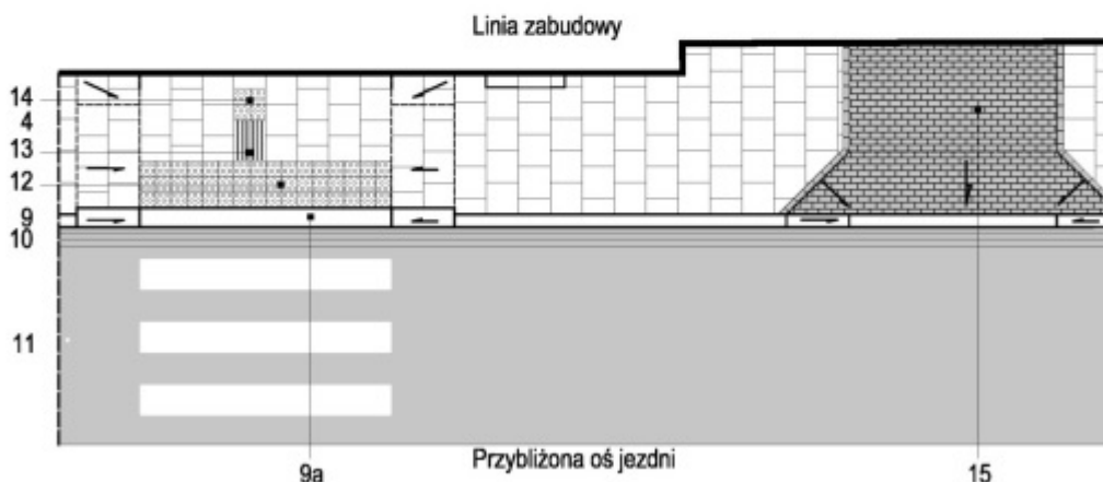
Rys. 38 Schemat 2 przykładowej ulicy niewielkich rozmiarów w strefie III (brak Pasa Technicznego)
