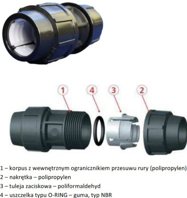
Rys. 23. Przykład złączki skręcanej do rury światłowodowej
