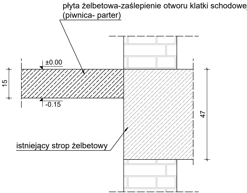
Przekrój 4-4 skala 1:10
