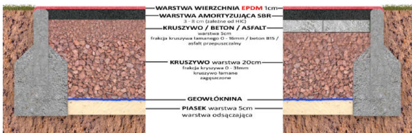
Nawierzchnia bezpieczna przekrój
