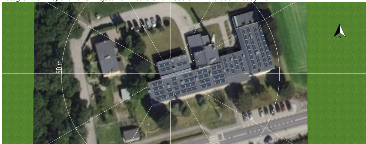
Fotografia 6. Proponowane miejsca rozmieszczenia modułów PV na dachu budynku
