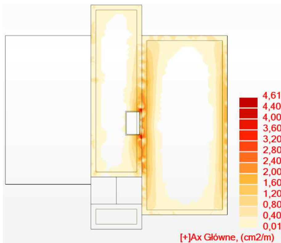
Rys.5. Strop nad piwnicą. Zbrojenie teoretyczne płyt Ax [+]
