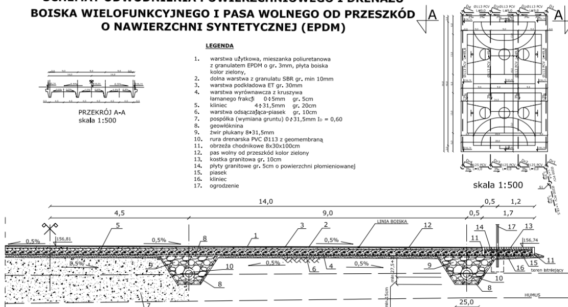
Rysunek 2 Przekrój przez warstwy boiska istniejącego
