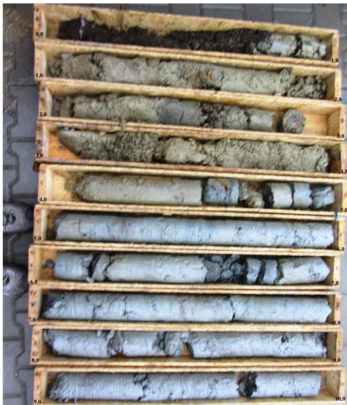
Fot. 3 - Rdzeń wiertniczy otworu Nr 2.
