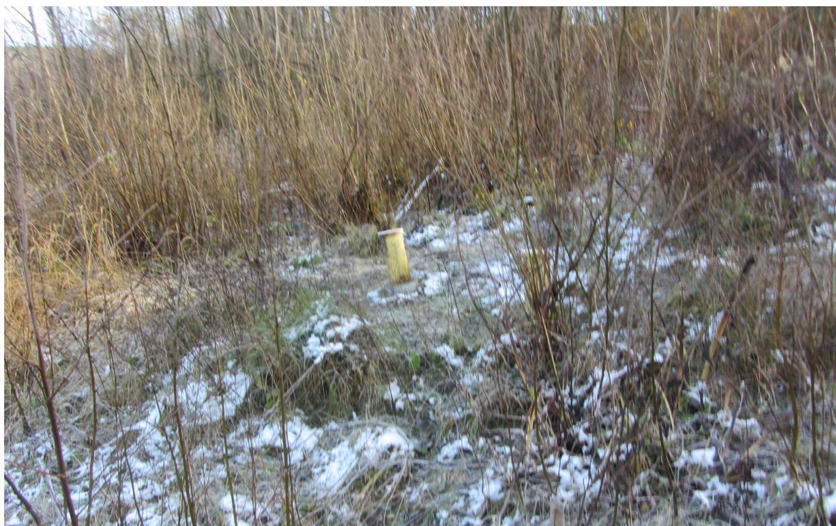
Fot.19 – Przechylony inklinometr TI-2
