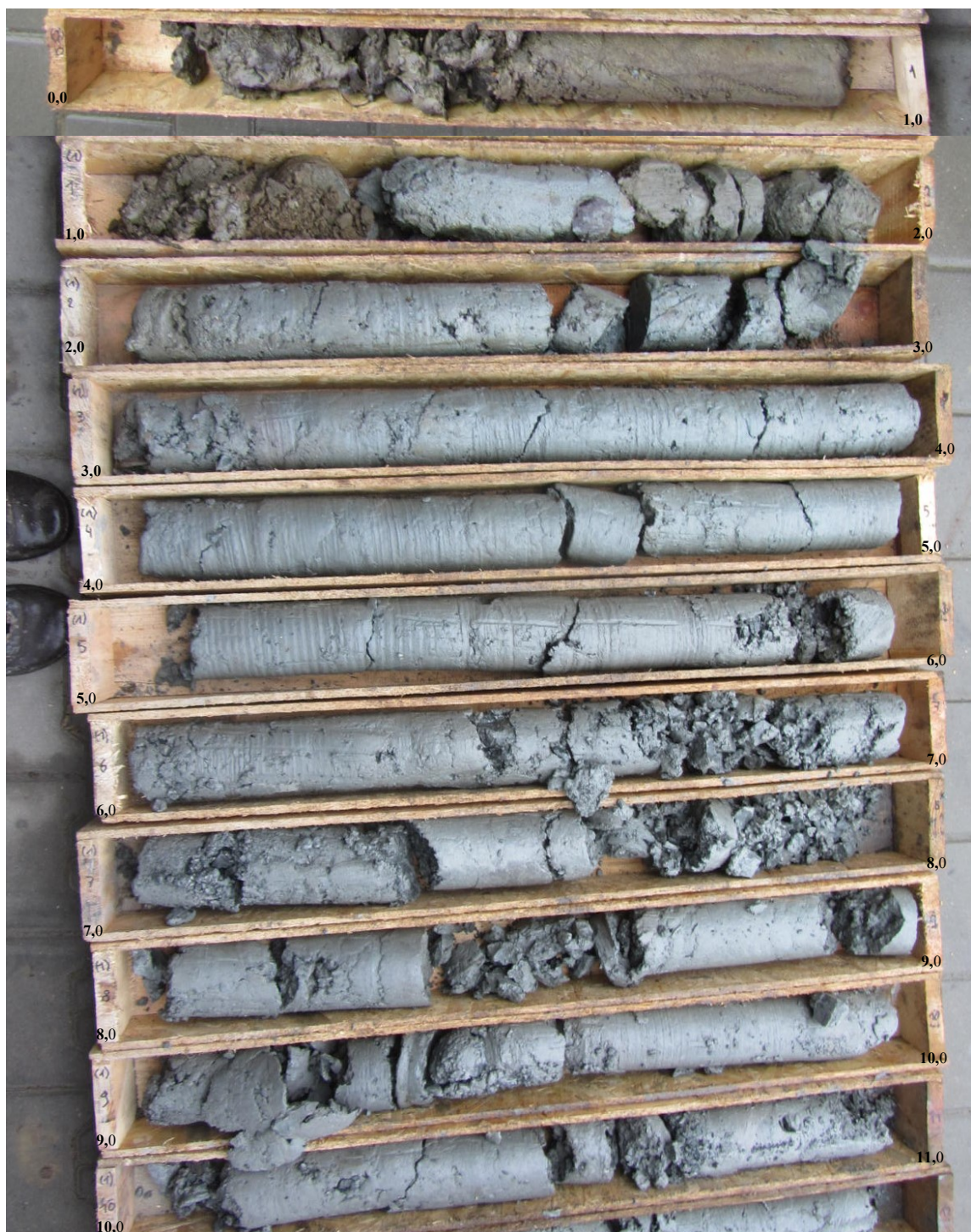
Fot. 1 - Rdzeń wiertniczy otworu Nr 1.
