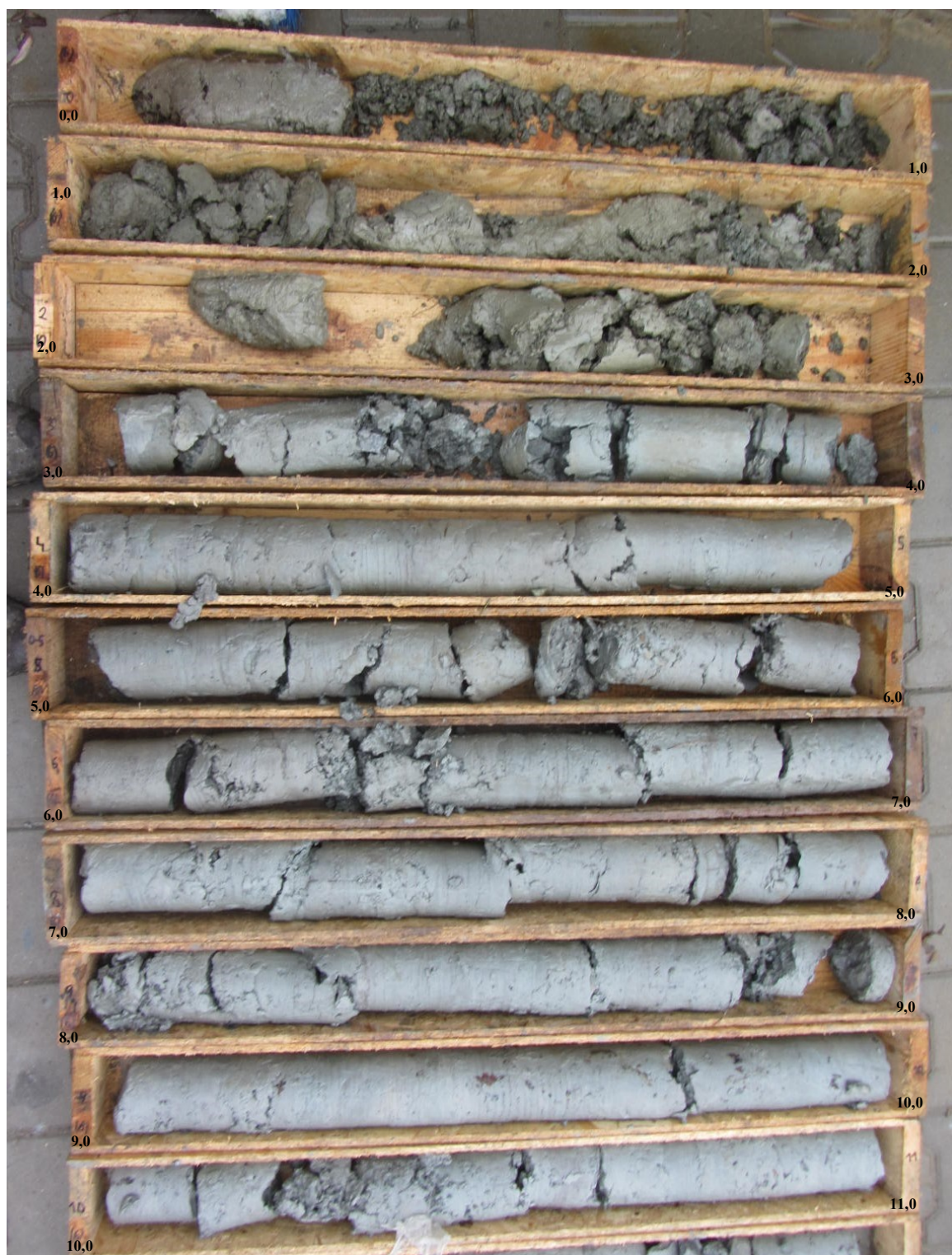
Fot.11 – Rdzeń wiertniczy otworu Nr 6.
