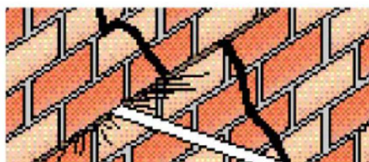
Rys. 6). Wyczyścić i odkurzyć bruzdy a następnie dokładnie spłukać wodą.
