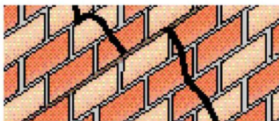
Rys. 5) W poziomych warstwach spoiny wyciąć (wyfrezować), szczeliny (bruzdy) o szer. 15mm i głębokości 35mm sięgające min. 50cm poza pęknięcie.
