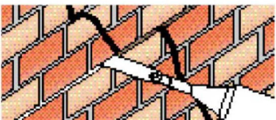
Rys. 7) Używając pistoletu do spoinowania wprowadzić pierwszą warstwę zaprawy do końca szczeliny.
