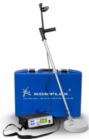
Rys. 17. Przykład urządzenia do lokalizacji markerów elektronicznych
