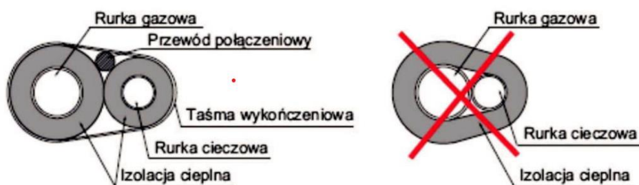
Sposób izolowania rurociągów
