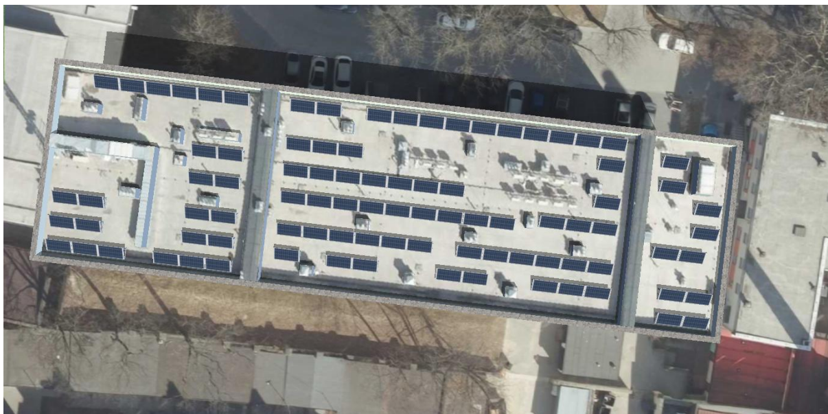
Rys. 9-4 | Mikroinstalacja fotowoltaiczna PV.B-VII - rozmieszczenie modułów fotowoltaicznych
