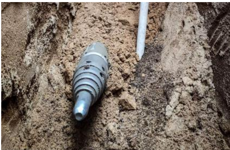
Rys. 27. Kret ciągnący rurę
