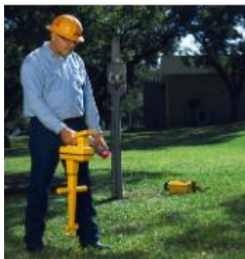
Rys. 40. Lokalizowanie i pomiar głębokości znaczników elektromagnetycznych
